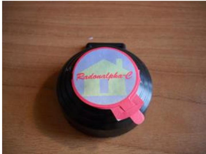
Figura 10 - Immagine dei dosimetri utilizzati per il monitoraggio Radon. I rivelatori a tracce nucleari di tipo Radonalpha-C sono costituiti da una camera di diffusione in plastica conduttiva all'interno della quale è posizionato un rivelatore costituito di una resina di derivazione ottica PoliAllilDiglicolCarbonato o PADC o più semplicemente CR-39.
